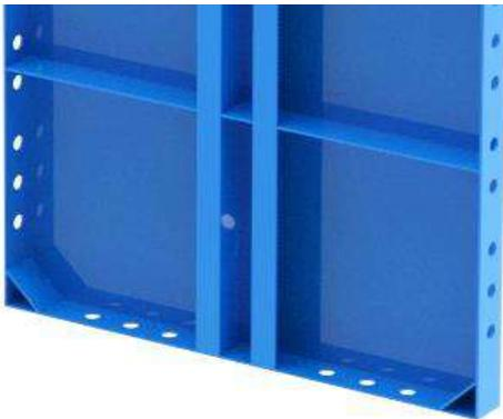
El diseño de refuerzo vertical central en los paneles EVI en forma de doble ángulo invertido funciona como alineador vertical incorporado dentro de la propia estructura del panel.
